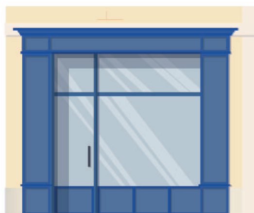
Devanture en panneaux bois en applique sur la façade
